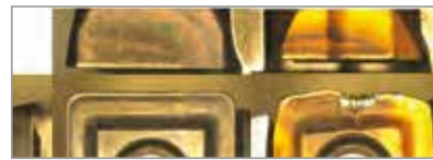
Wettbewerb B 140 Bohrungen (13 m) Verschleiß und Abplatzen an der Schneidkante
